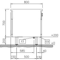
Electrical inlet (power) EQ Equipotential screw
